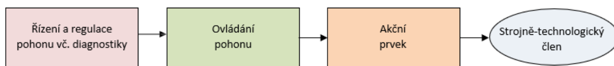
Obrázek 2: Základní schéma složení průmyslových pohonů
